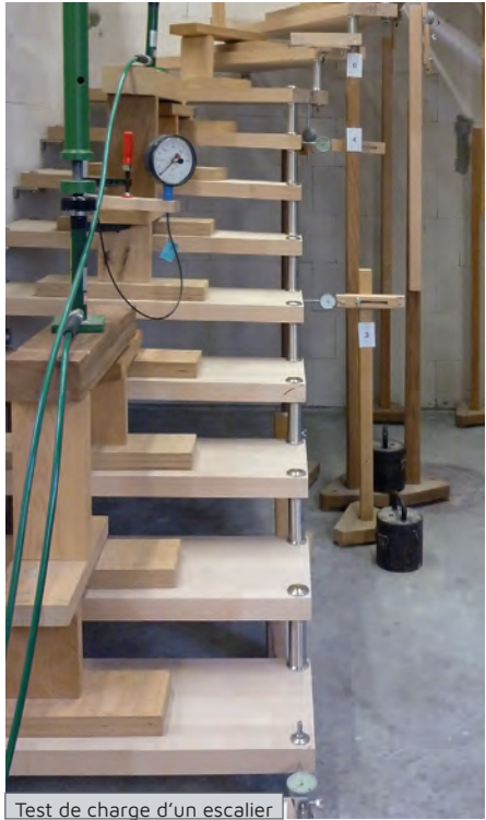
Test de charge d’un escalier
