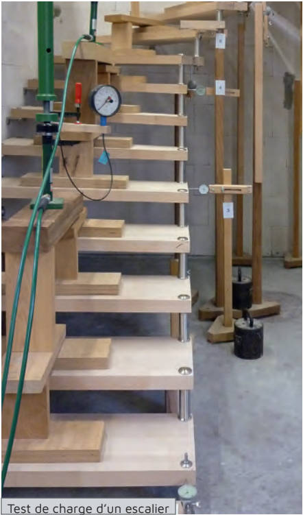
Test de charge d’un escalier
